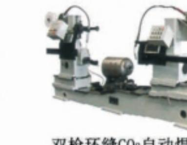
双枪环缝CO<sub>2</sub>自动焊接机
