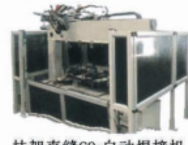
挂架直缝CO<sub>2</sub>自动焊接机
