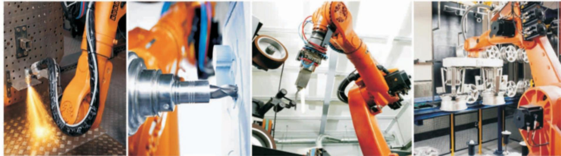
机器人削磨自动化系统可以替代人工和去毛刺的机床设备，用于对铸件、钣金工件、洁具、电脑笔记本、手机等壳体的打磨、去毛刺自动化加工以及适合多种软金属软材料，如铝、塑料、木料、玻璃行业，碳化纤维、复合材料等大型、复杂工件的高速铣削、钻削、雕刻加工。库维为您提供专业的非标准件切削磨解决方案，帮助您解决加工生产自动化的难题，助推生产力提升。
