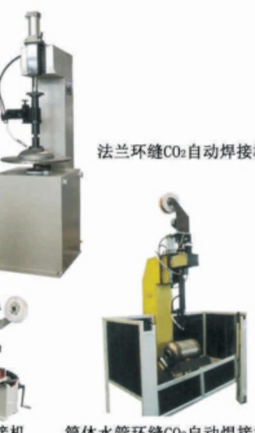
法兰环缝CO<sub>2</sub>自动焊接机
