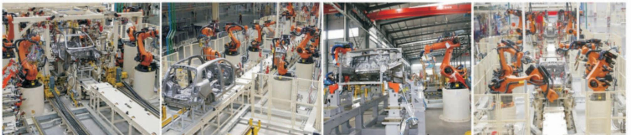
为用户提供汽车整车及零部件焊装工艺所需的生产线、机器人系统、专用成套设备、夹治具及运输装置等，在广汽、丰田TOYOTA、东风日产、奥迪、一汽大众、GM通用等用户处成功实施多个开发、设计、制造的“交钥匙”工程。
